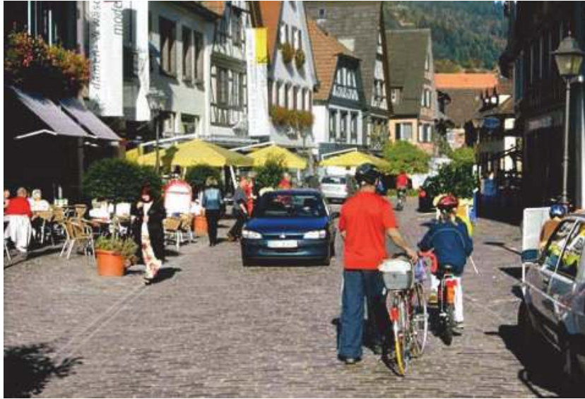
Slika 22: Primer izvedbe skupnega prometnega prostora
