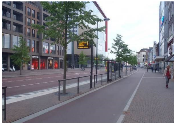
Slika 31: Primeno omejen koridor za prehod pešcev preko kolesarske steze pri avtobusnem postajališču v Utrechtu – NL (Polona Demšar Mitrovič)
