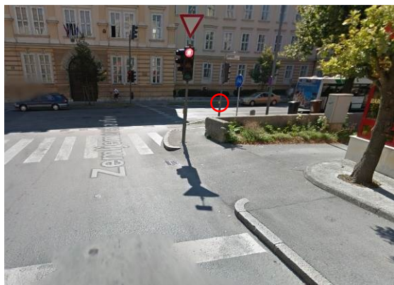
Slika 80: Neprimerno locirano stikalo za skrajšanje intervala zelene luči. Stop črta je pred uvozom z desne, dostop do stikala le preko pločnika za pešce. (Vir: GoogleMaps)
